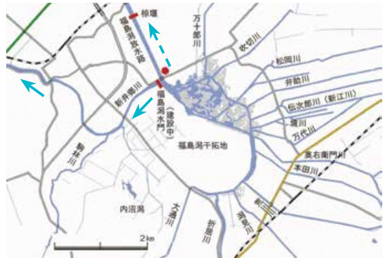
図2 福島潟に流入する13河川と流出河川 洪水時には福島潟放水路より排水 --->
